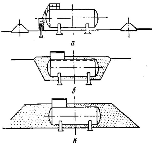
Рис. 4.54. Схеми установки надземних і підземних циліндрических резервуарів: а – надземна; б – підземна; в – із засипанням
