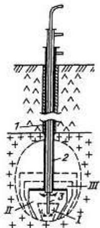
Рис. 3.20. Схема споруди підземної виробки-місткості ступенями від низу до верху:
