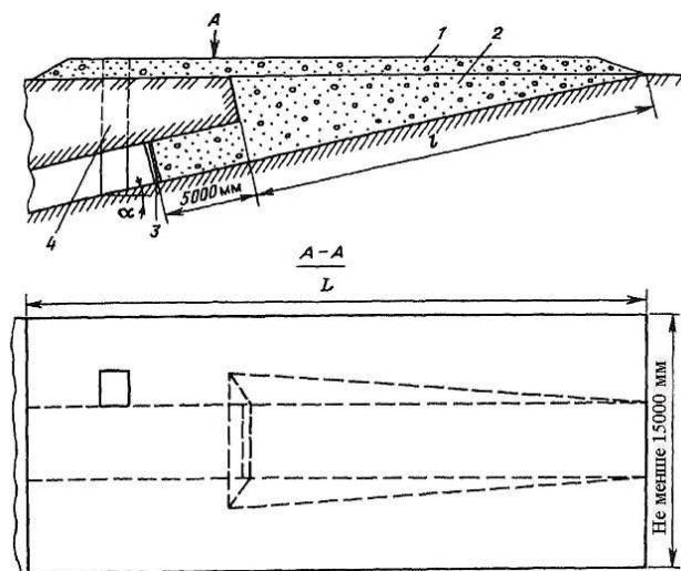
Рис. 3.14. Схема герметизації устя стовбура:
