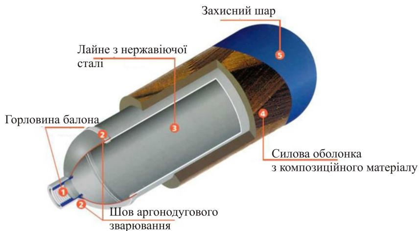
Рис. 4.82. Конструкція металокомпозитного балона для зріджених вуглеводневих газів
