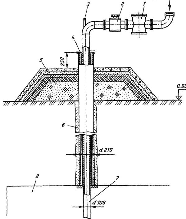
Рис. 3.16. Схема технологічної свердловини для заповнення виробок-місткостей нафтопродуктом: 1 – сітчастий фільтр; 2 – рідинний лічильник; 3 – термошиеня; 4 – теплоізоляція; 5 – теплогідроізоляція оголовка свердловини; 6 – обсадна колона; 7 – внутрішня (робоча) колона; 8 – виробка-місткість
