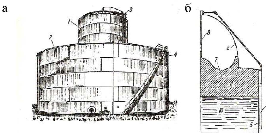
Рис. 2.43. Резервуари з газокомпенсатором: а – циліндричний, б – схема куполоподібного газокомпенсатора (1 – циліндричний газокомпенсатор об'ємом  $210\text{ м}^3$ ; 2 – резервуар місткістю  $1810\text{ м}^3$ ; 3 – майданчик для обслуговування; 4 – сходи; 5 – корпус; 6 – напівсферичне покриття; 7 – гнучка мембрана; 8 – трос; 9 – покажчик положення мембрани; 10 – нафтопродукт; 11 – газовий простір)
