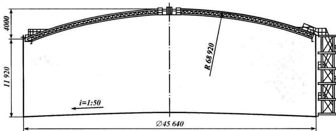
Рис. 2.20. Резервуар об'ємом  $20\,000 \text{ м}^3$  зі сферичним каркасним покриттям
