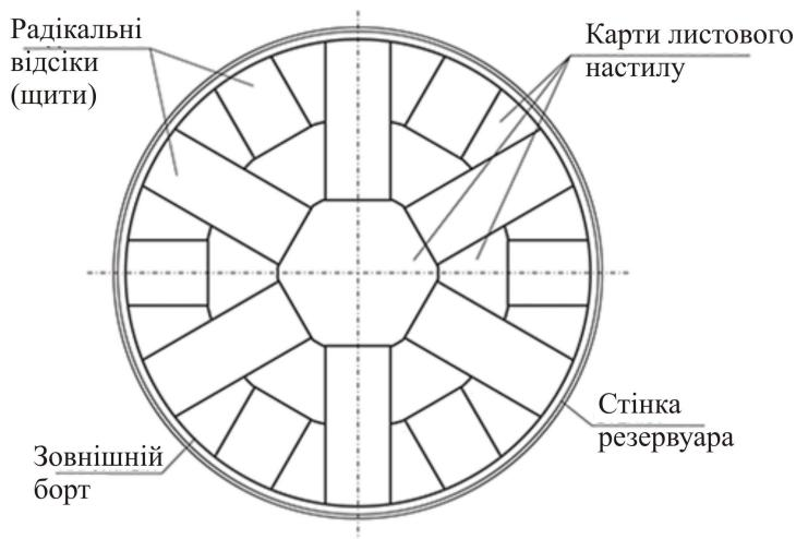
Рис. 2.29. Однодечний щитовий понтон
