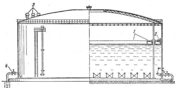
Рис. 2.25. Резервуар вертикальний сталевий з понтоном:
