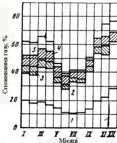
Рис. 4.4. Річний графік добового споживання газу в великому місті: 1 – промисловість; 2 – електростанціями; 3 – комунально-побутове; 4 – у житлових будинках; 5 – на опалення і вентиляцію будівель
