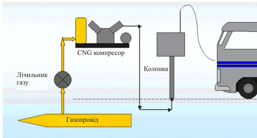
Рис. 4.41. Технологічна схема роботи повільної заправки
