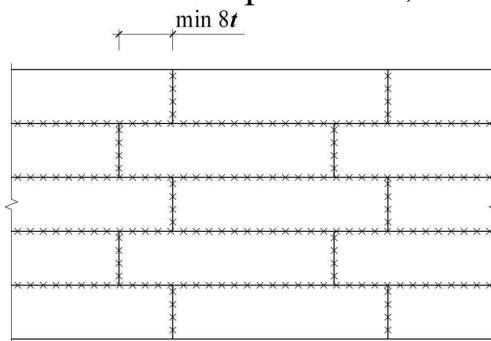
Рис. 2.9. Компонування листів стінки для полистового способу монтажу
