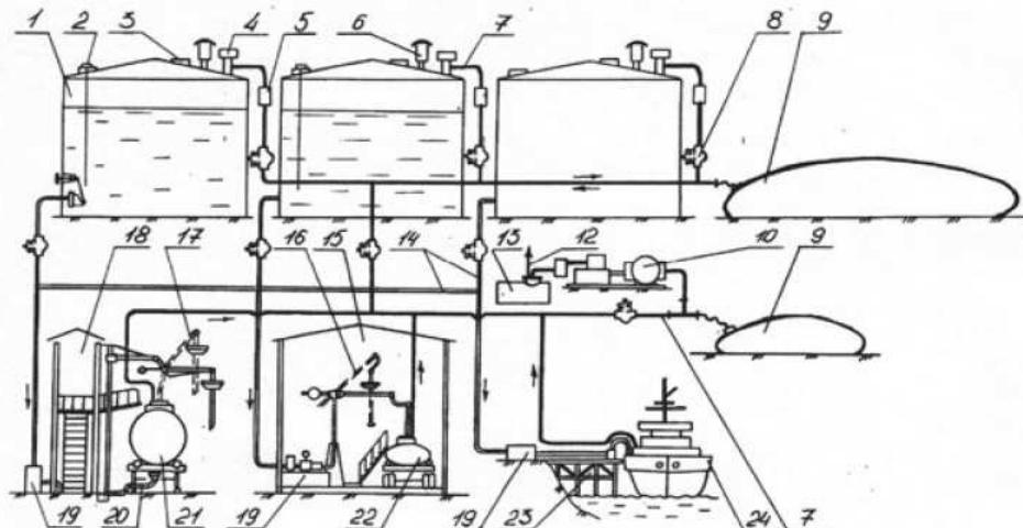
Рис. 2.45. Газова обв'язка з м'якими газгольдерами на нафтобазі:
