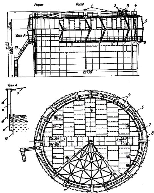
Рис. 2.38. Резервуар з підйомним «дихаючим» дахом (дзвоном): 1 – сигнал світловий; 2 – дихальний клапан; 3 – клапан запобіжний; 4 – майданчик для вантажів; 5 – важільний стабілізатор; 6 – настил даху; 7 – кронштейн стабілізатора; 8 – балкон; 9 – крокви; 10 – драбина; 11 – пояс даху; 12 – корпус резервуара; 13 – гідравлічний затвор; 14 – захисний кожух; 15 – кільце жорсткості
