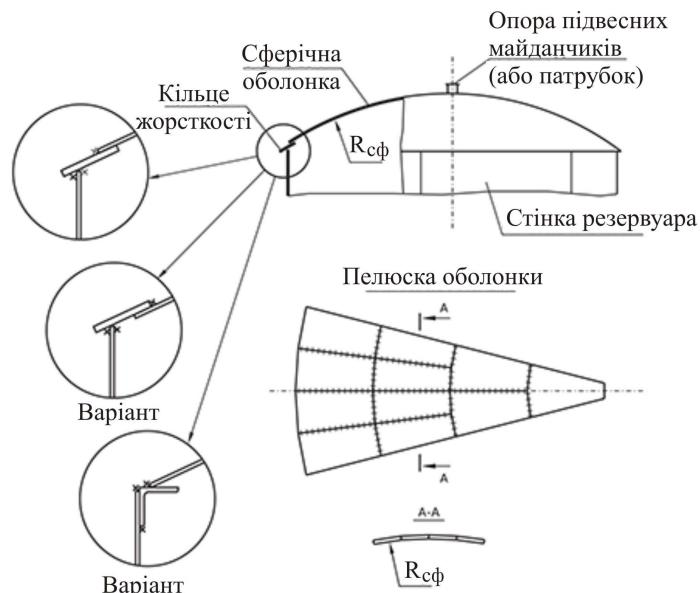
Рис. 2.15. Сферичний безкаркасний дах
