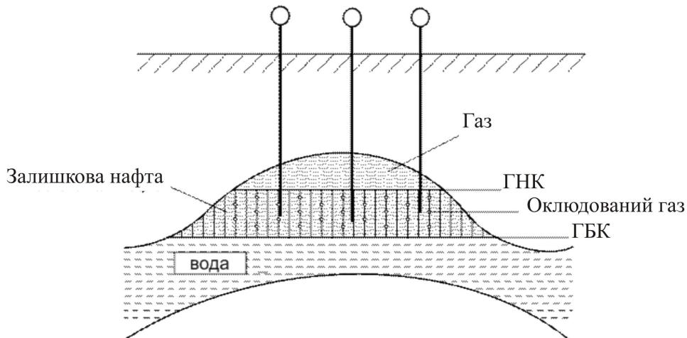
Рис. 4.46. Схематичний розріз нафтового покладу масивного типу в кінці розробки
