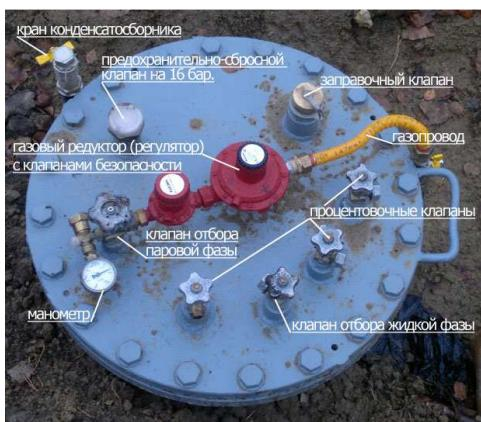
Рис. 4.59. Розташування арматури на кришці підземного газгольдера
