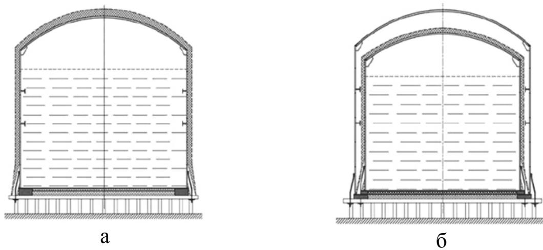
Рис. 4.51. Вертикальні ізотермічні резервуари: а – одностінний із зовнішньою ізоляцією; б – двостінний резервуар з двома самонесучими дахами
