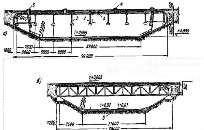
Рис. 2.63. Заглиблений траншейний комбінований резервуар місткістю 10 000 м<sup>3</sup> для світлих нафтопродуктів: а) поздовжній розріз; б) поперечний розріз; 1 – сталеві облицювання товщиною 4 мм; 2 – збірні залізобетонні блокові ферми; 3 – збірні залізобетонні плити; 4 – світловий люк; 5 – люк-лаз; 6 – дренажний лоток
