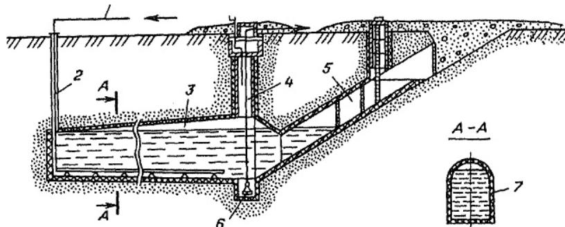
Рис. 3.6. Схема шахтного резервуара в вічномерзлих породах:
