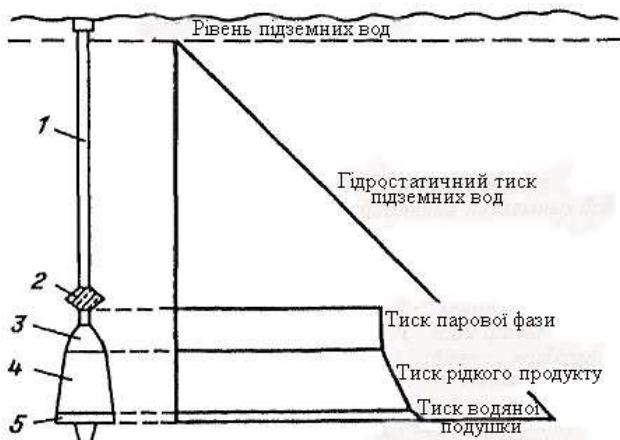
Рис. 3.4. Принципова схема герметизації резервуара з притоком підземних вод у виробку-місткість: 1 – ствол; 2 – перемичка; 3 – парова фаза; 4 – рідкі вуглеводні у виробці-місткості; 5 – вода
