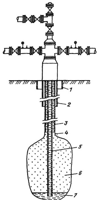
Рис. 3.24. Схема обладнання підземного резервуара для зберігання світлих нафтопродуктів: 1 – напрямок; 2 – кондуктор; 3 – обсадна колона; 4 – незакріплена ділянка свердловини; 5 – експлуатаційна колона; 6 – рідкі вуглеводні; 7 – розсол
