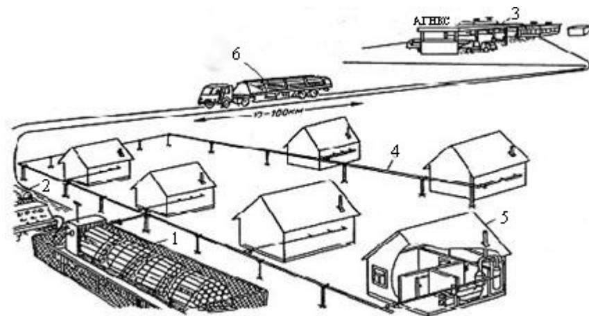
Рис. 4.31. Стационарні газоакумулятори в складі системи автономного газозабезпечення селища за системою «віртуальна труба»: 1 – стационарний газоакумулятор; 2 – напівпричеп-газовоз у процесі розвантаження; 3 – АГНКС; 4 – газова мережа селища; 5 – споживачі (газові котел, колонка, плита); 6 – газовоз
