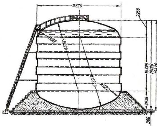
Рис. 2.39. Вертикальний циліндричний резервуар із сферичним дахом і днищем
