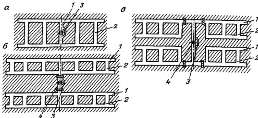
Рис. 3.8. Схеми шахтних сховищ камерного типу із замкнутою системою виробок-місткостей для одного (а), двох (б) і чотирьох (в) продуктів: 1 – виробки-місткості; 2 – збійки між виробками-місткостями; 3 – обхідна виробка; 4 – розкривна виробка
