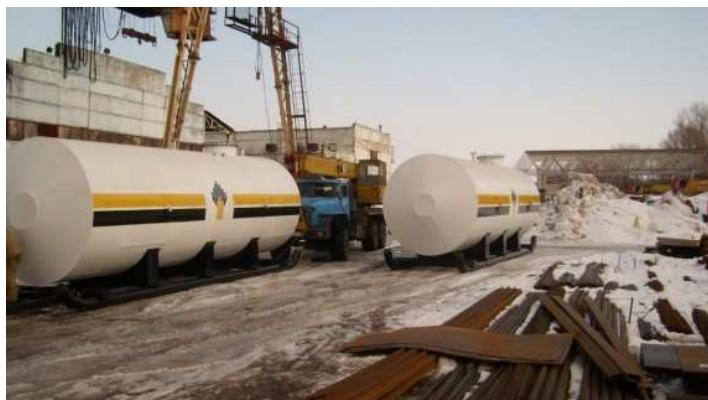
Рис. 2.48. Пересувний горизонтальний циліндричний резервуар (на санчатах)
