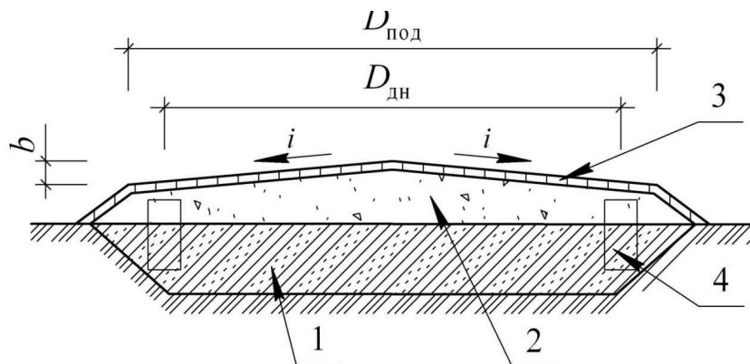
Рис. 2.54. Схема влаштування основи під резервуар:
