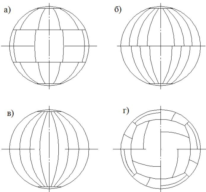
Рис. 4.23. Розкрій оболонки сферичних резервуарів:
