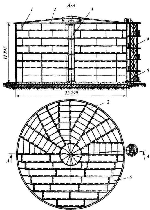
Рис. 2.18. . Резервуар об'ємом  $5000 \text{ м}^3$  з конічним щитовим покриттям:
