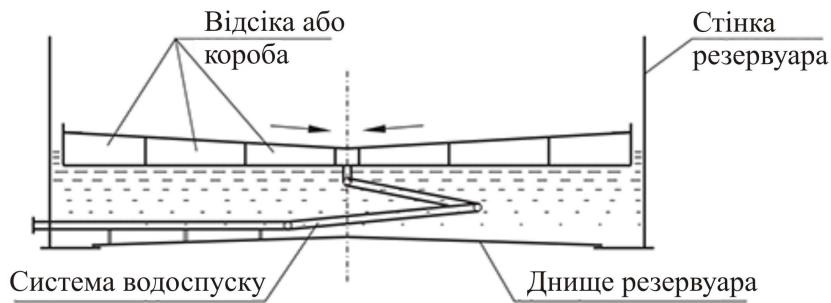
Рис. 2.35. Дискові плаваючі дахи резервуарів
