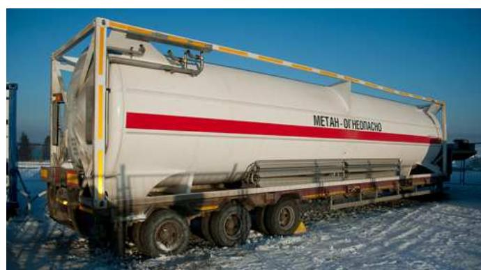
Рис. 4.72. 48-футовий танк-контейнер для метану на автомобільному напівпричепі
