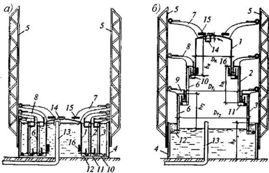
Рис. 4.6. Схема мокрого газгольдера з вертикальними напрямними
