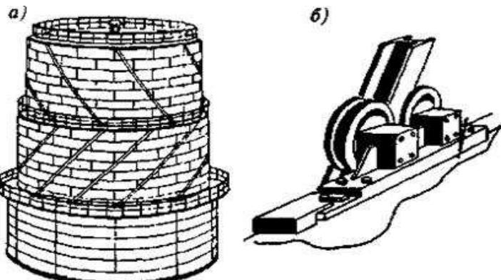
Рис. 4.8. Мокрий газгольдер з гвинтовими напрямними: а) загальний вигляд (рухомі секції розсунуті); б) конструкція роликів і гвинтової напрямної
