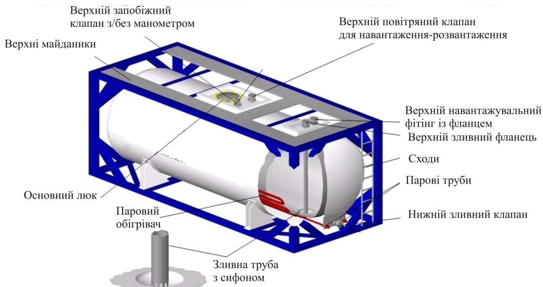
Рис. 4.73. Конструкція контейнера для зріженого нафтового газу з будованим контуром нагріву газу
