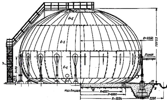
Рис. 2.40. Осесиметричний краплеподібний резервуар з екваторіальною опорою
