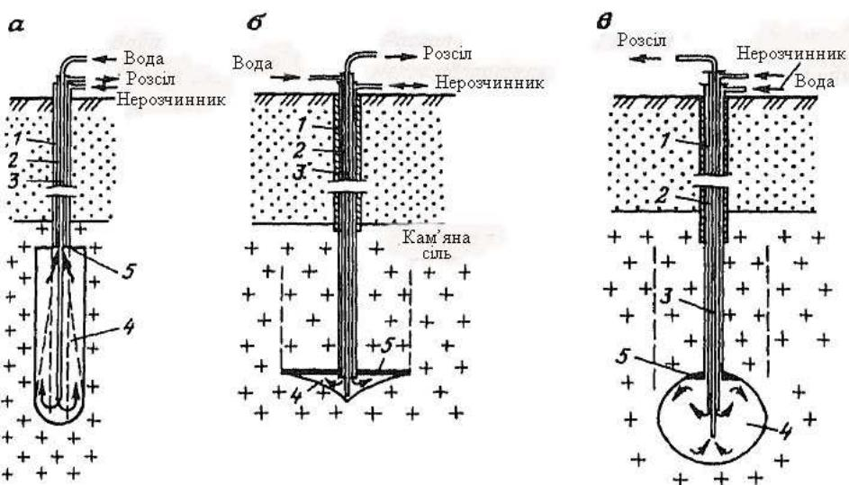
Рис. 3.19. Схеми основних технічних режимів подачі розчинника:
