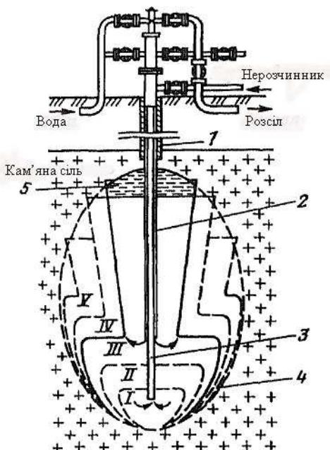
Рис. 3.22. Схема комбінованого методу спорудження підземної виробки-смісності: 1 – обсадна колона труб; 2, 3 – відповідно зовнішня і центральна підвісні колони; 4 – контур проектної виробки-смісності; 5 - нерозчинник; I, II, III, IV, V – ступені
