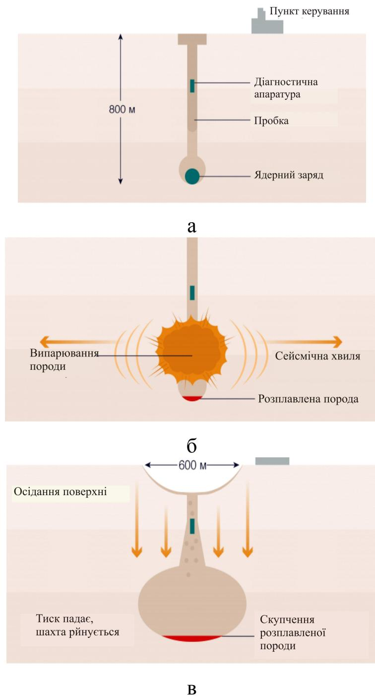
Рис. 4.49. Стадії створення підземної порожнини в результаті ядерного вибуху: а – підготовка; б – підривання; в – утворення порожнини
