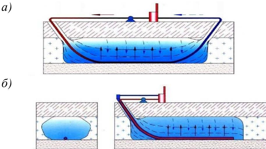
Рис. 3.17. Спорудження сховищ в товщі льоду: а) розмив одночною свердловиною; б) розмив двома свердловинами
