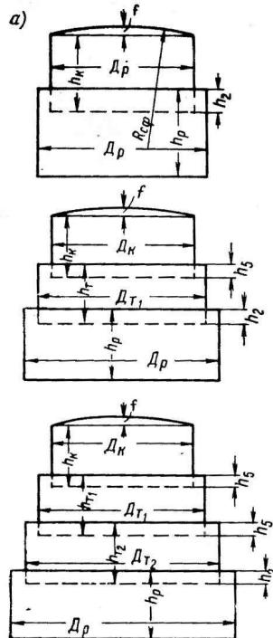
Рис. 4.16. Розрахункова схема газгольдера з вертикальними напрямними
