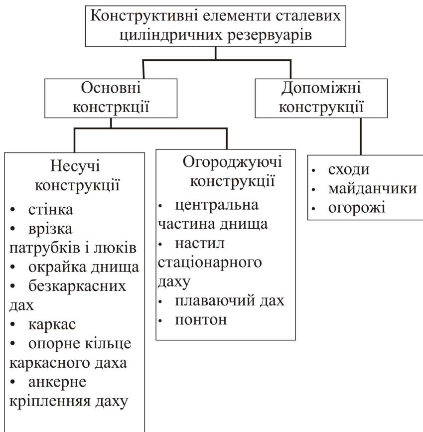
Рис. 2.1. Класифікація елементів вертикальних циліндричних резервуарів
