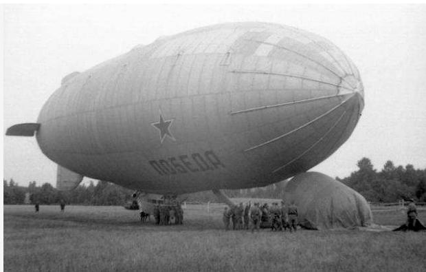
Рис. 4.3. Заправка м'якого газгольдера від дирижабля-газовоза
