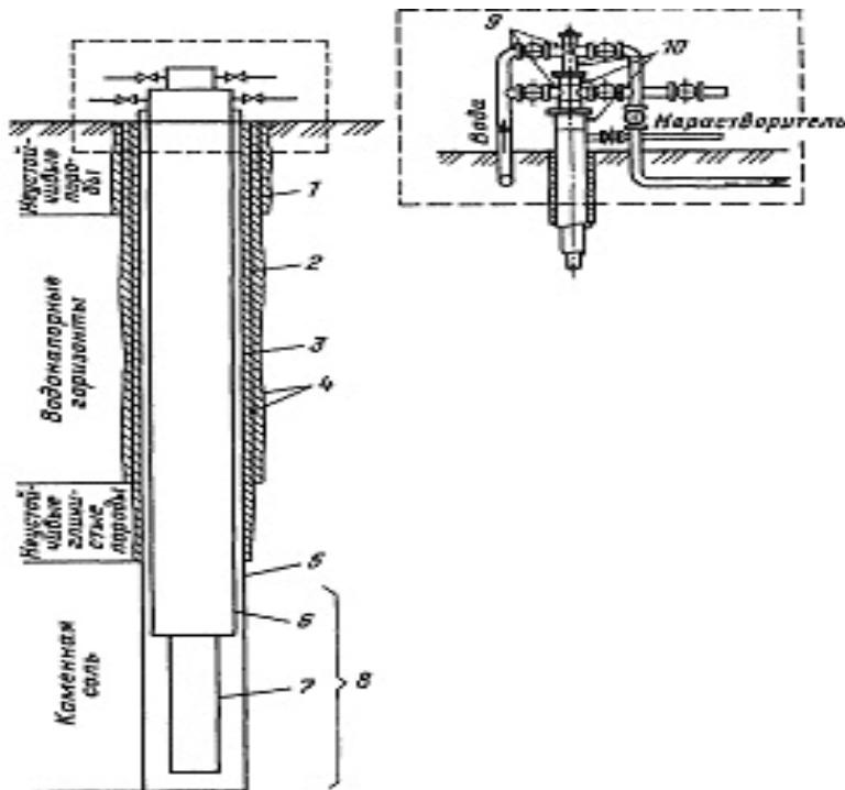
Рис. 3.23. Конструкція свердловини, підготовленої до спорудження безшахтного резервуара: 1 – напрямок; 2 – кондуктор; 3 – основна обсадна колона; 4 – цементний камінь; 5 – необсаджена частина свердловини; 6, 7 – відповідно зовнішня і центральна підвісні колони; 8 – інтервал залягання підземного резервуара; 9 – термошиена; 10 – пробовідвідні крани
