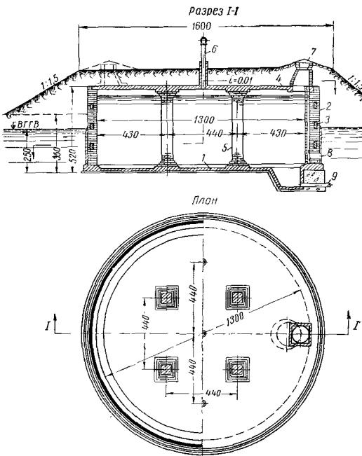
Рис. 2.55. Кам'яний резервуар, посиленій залізобетонними кільцями (залізобетонні кільця заштриховані): 1 – залізобетонне днище; 2 – кам'яний (цегляний) корпус, посиленій залізобетонними кільцями; 3, 4 – залізобетонні перекриття; 5 – кам'яні колони; 8 – приймально-роздавальний патрубок; 9 – труба для бруду
