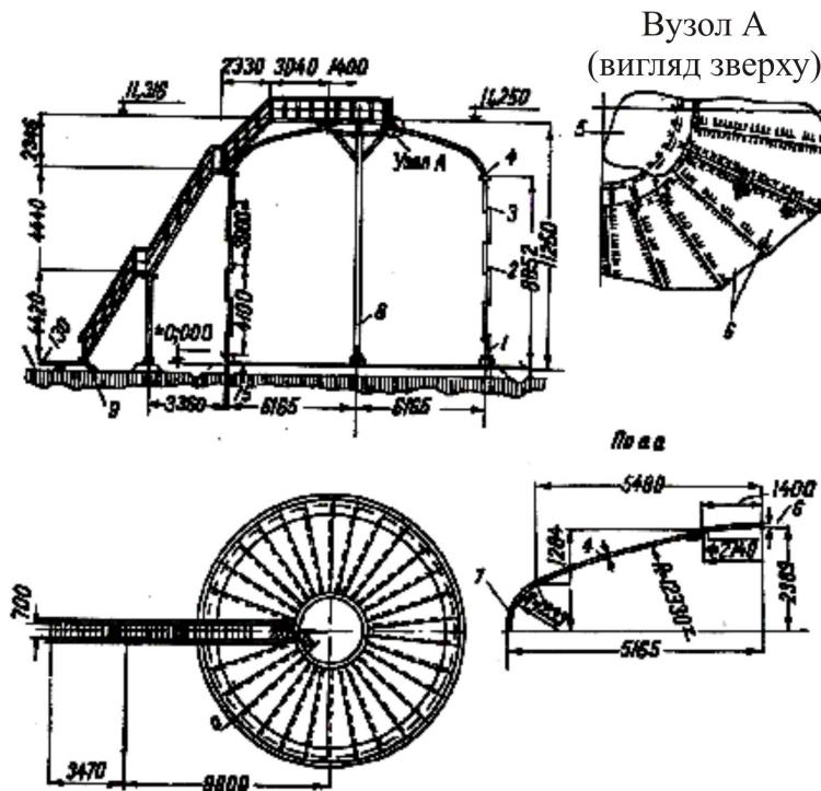
Рис. 2.21. Вертикальні сталеві циліндричні резервуари із сфероциліндричною покрівлею
