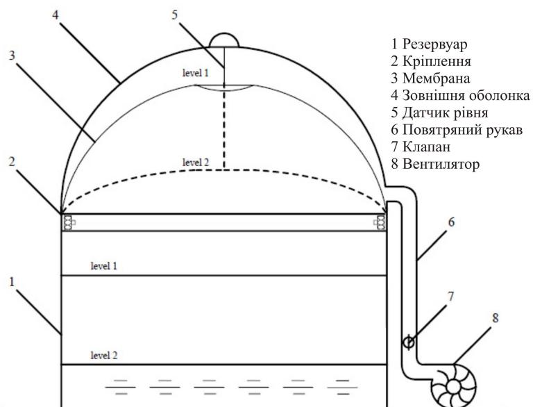
Рис. 2.44. Конструкція купольного газгольдера-рекуператора
