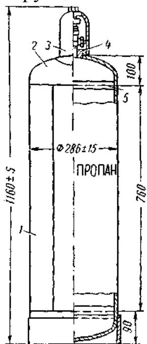
Рис. 4.78. Конструкція балона об'ємом 50 л для зрідженого пропан-бутану:
