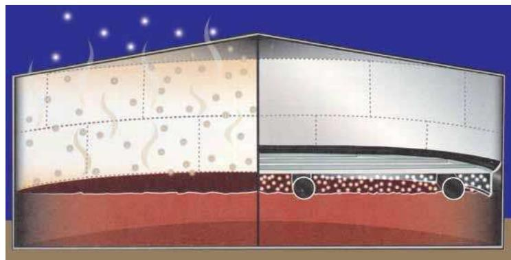
Рис. 2.24. Газовий простір резервуарів РВС і РВСП
