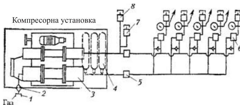
Рис. 4.40. Принципова технологічна схема гаражної АГНКС:
