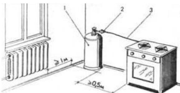
Рис. 4.84. Розміщення газового балона в приміщенні
