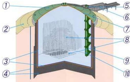
Рис. 4.67. Заглиблений залізобетонний резервуар з термоізольованим дахом: 1 – купольний дах; 2 – берма; 3 – ізоляція стінки і днища; 4 – підігрівач; 5 – насосний майданчик; 6 – трубопровідна обв'язка та естакада; 7 – ізоляція даху; 8 – мембрана; 9 – стінка та основа; 10 – каркас поршневого насоса
