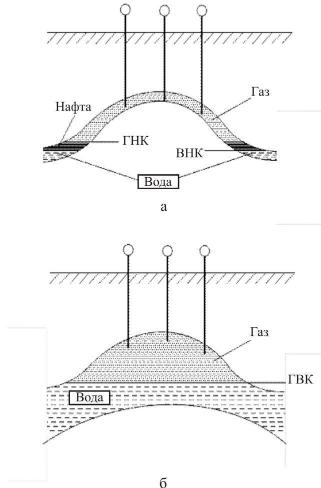
Рис. 4.47. Схематичне зображення процесу експлуатації пласта-колектора: а – пласт невеликої потужності в слабоз cementованому колекторі; б – пласт великої потужності в міцноз cementованому колекторі
