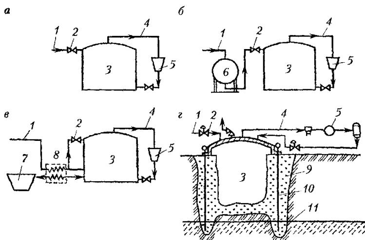
Рис. 4.68. Ізотермічні резервуари: *а* – з холодильною установкою; *б* – з буферними посудинами; *в* – з проміжним хладоагентом; *г* – льодопородний (1 – зливний трубопровід; 2 – дросельний пристрій; 3 – резервуар; 4 – трубопровід парової фази; 5 – компресорна холодильна установка; 6 – буферна місткість, 7 – місткість для проміжного хладоагенту; 8 – теплообмінник; 9 – льодогрунтовая оболонка, 10 – морозильні колонки; 11 – водонепроникний шар підстилаючих порід)
