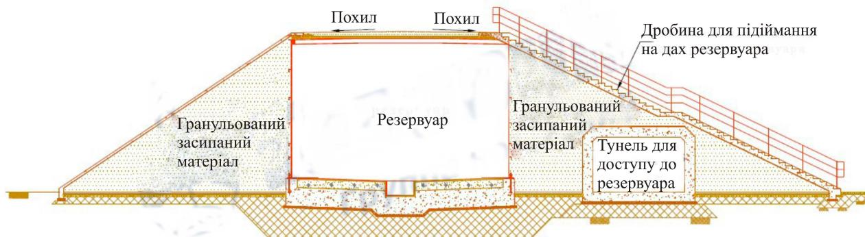
Рис. 2.51. Вертикальний сталевий циліндричний резервуар для авіаційного палива з ґрутовим насипом
