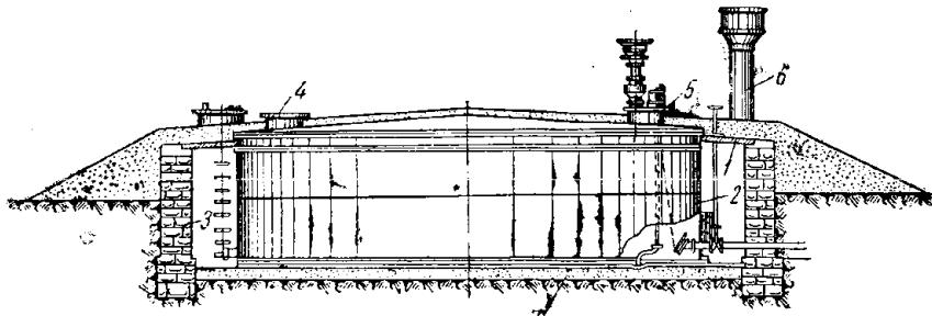
Рис. 2.50. Казематний резервуар: 1 – плити перекриття; 2 – резервуар; 3 – стінка каземату; 4 – світловий люк; 5 – люккерування; 6 – вентиляційна труба; 7 – піщана підсипка
