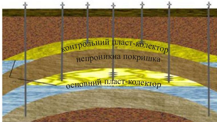
Рис. 4.44. ПСГ на базі відпрацьованого газового (газоконденсатного) родовища
