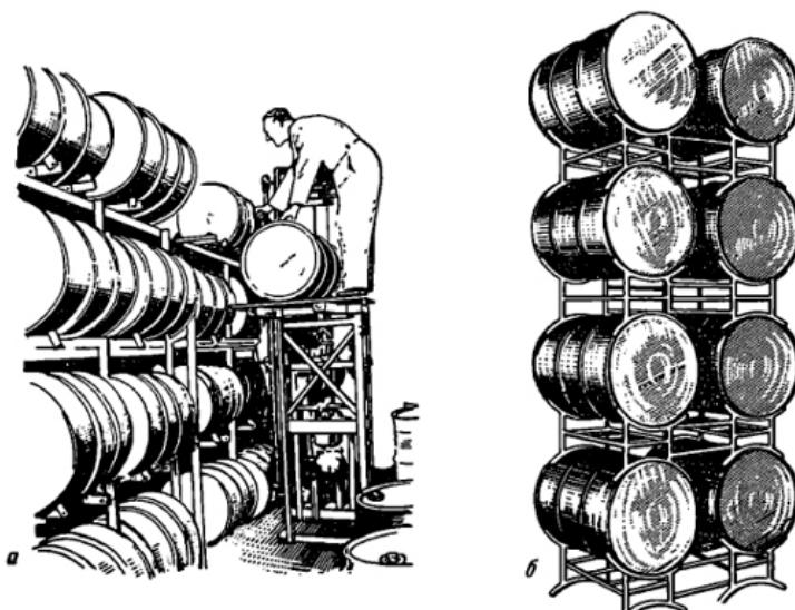
Рис. 2.74. Навантаження й зберігання бочок на стелажах:
