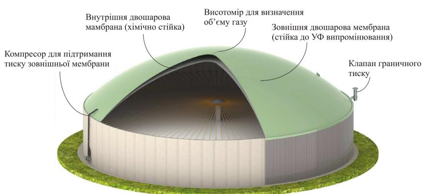
Рис. 4.25. Двокамерний агрегатований газгольдер постійного тиску з метантенком
