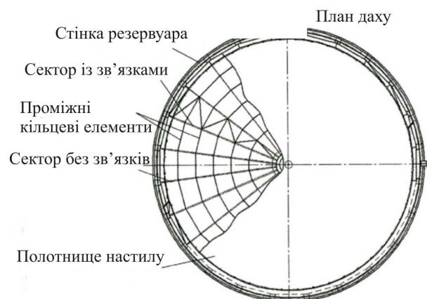
Рис.2.19. Циліндричний РВС із каркасним конічним дахом:
