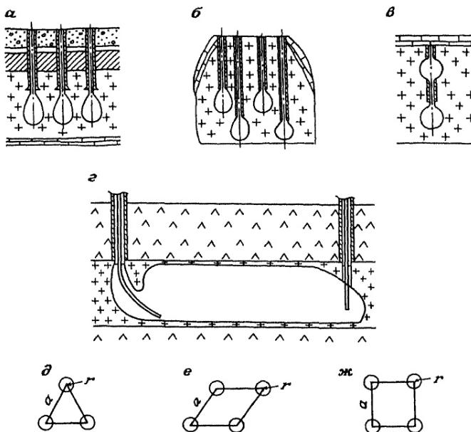
Рис. 3.18. Принципові об'ємно-планувальні схеми безшахтних резервуарів у кам'яній солі (а-г) і плани розташування виробок-емностей за трикутною (д), ромбічною (е) і квадратною (ж) сітками
