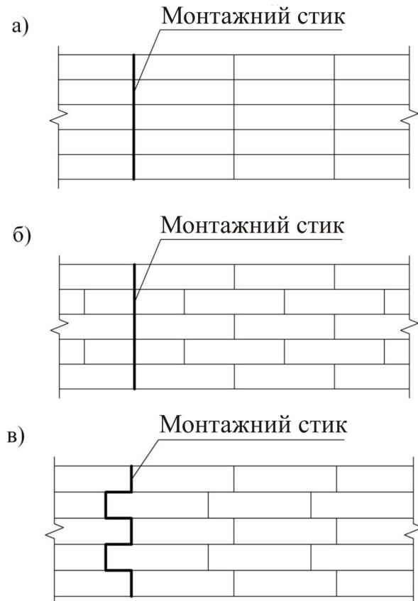
Рис. 2.10. Компонування листів стінки для рулонного способу монтажу
