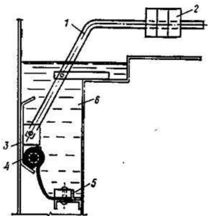
Рис. 4.13. Поперечний розріз затвора сухого газгольдера з рідинним ущільненням: 1 – важіль; 2 – вантажі; 3 – кільце; 4, 5 – фартух; 6 – масло
