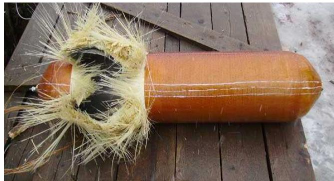
Рис. 4.80. Композитний балон після вибуху
