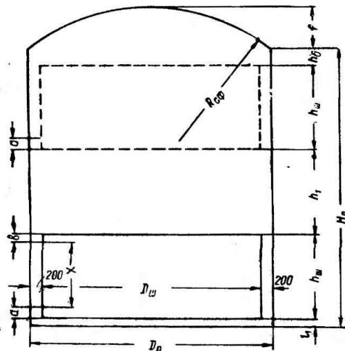
Рис. 4.17. Геометрична схема сухого газгольдера з еластичною секцією
