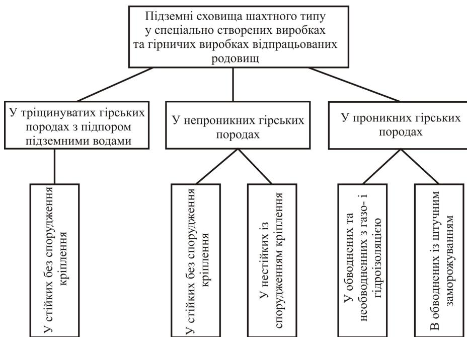
Рис. 3.3. Класифікація підземних сховищ шахтного типу
