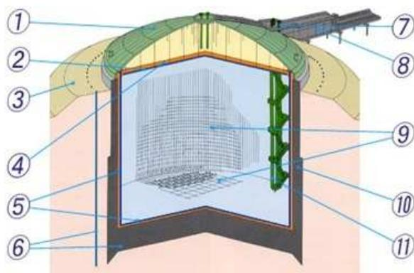
Рис. 4.66. Залізобетонний заглиблений резервуар з підвісною платформою: 1 – купольний дах; 2 – підвісна платформа; 3 – берма (горизонтальна площа на схилі); 4 – ізоляція на підвісній платформі; 5 – ізоляція стінки і днища; 6 – підігрівач; 7 – насосний майданчик; 8 – трубопровідна обв'язка та естакада; 9 – мембрана; 10 – стінка і підставка; 11 – каркас поршневого насоса
