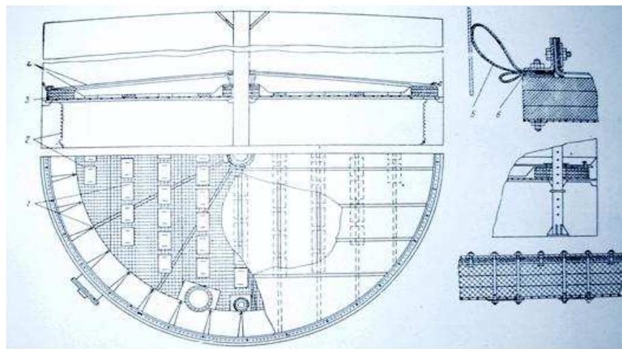
Рис. 2.30. Понтон із синтетичних матеріалів: 1 – кріпильні деталі; 2 – сітка; 3 – поплавки; 4 – верхній і нижній килими; 5 – ущільнювальний затвор; 6 – кільце жорсткості
