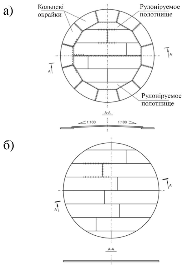
Рис. 2.2. Конструктивні рішення днищ резервуарів: а – конічне з кромками; б – пласке
