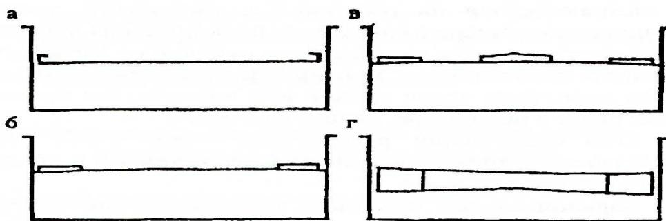
Рис. 2.34. Основні типи плаваючих дахів: а – дисковий; б – одношаровий з кільцевим коробом; в – одношаровий з кільцевим і центральним коробом; г – двошаровий
