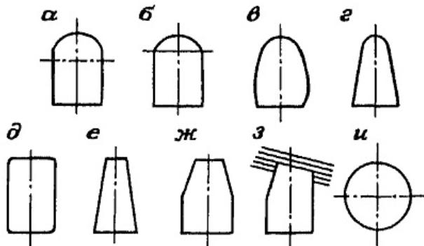
Рис. 3.11. Форми поперечних перерізів виробок-місткостей:
