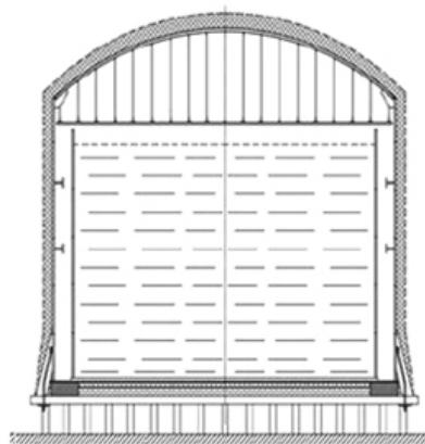
Рис. 4.52. Двостінний резервуар з підвісним дахом внутрішнього резервуара
