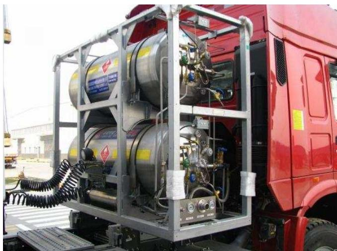
Рис. 4.83. Балони із зрідженим метаном на тягачі
