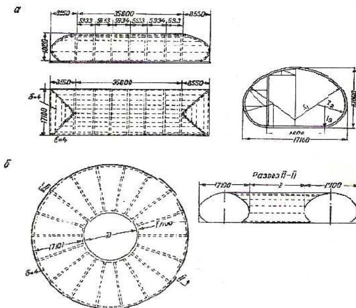
Рис. 2.42. Осесиметричний краплеподібний циліндричний (а) і торокрапельний (б) резервуари
