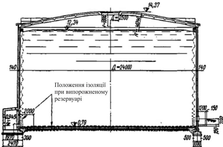
Рис. 2.59. Наземний залізобетонний збірний резервуар з гофрованою еластичною ізоляцією
