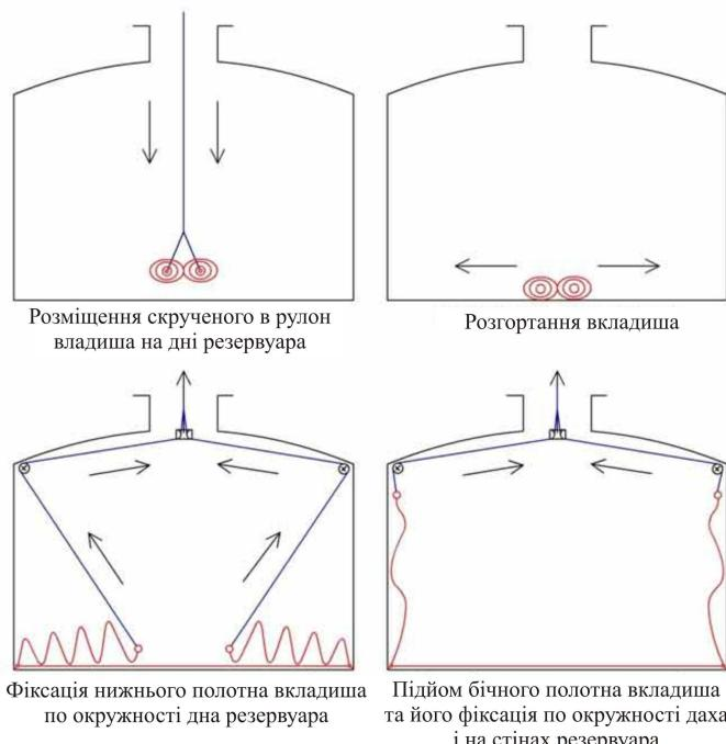
Рис. 2.72. Ремонт резервуара за допомогою монтажу полімерного лайнера
