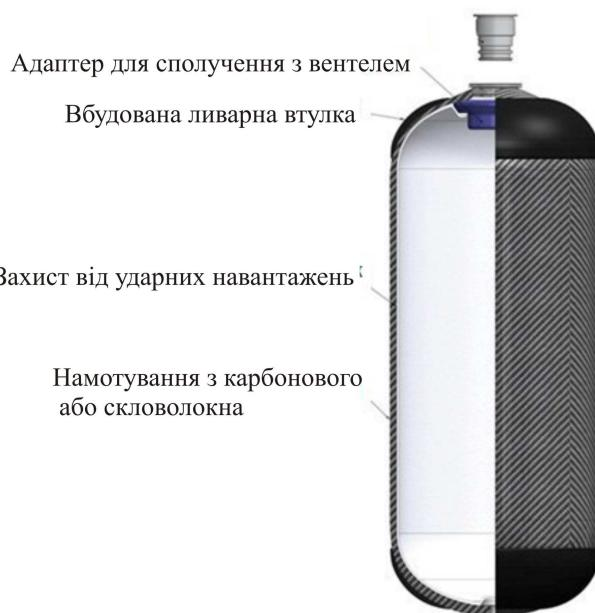
Рис. 4.79. Конструкція композитного балона для зрідженого пропан-бутану
