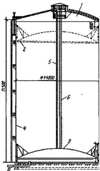
Рис. 4.12. Схема сухого газгольдера поршневого типу об'ємом 100 000 м<sup>3</sup>:
