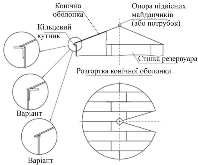
Рис. 2.14. Конічний безкаркасний дах
