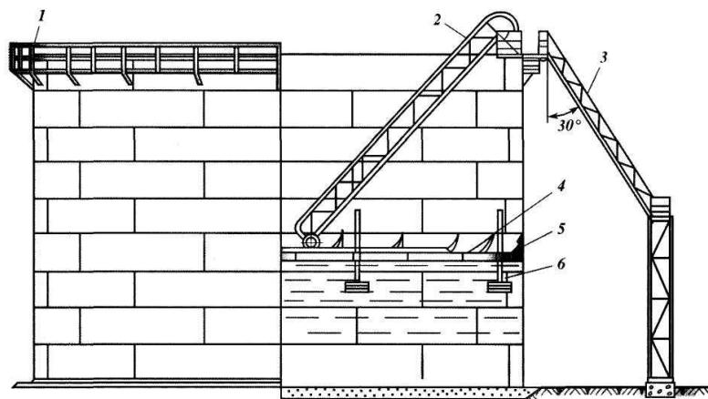
Рис. 2.33. Резервуар з дводечним плаваючим дахом: 1 – перила; 2, 3 – рухомі і нерухомі сходи; 4 – плаваючий дах; 5 – затвор; 6 – опорний стояк
