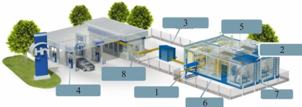
Рис. 4.36. Типове планування АГНКС з подачею газу по трубопроводу: 1 – блок вхідних кранів; 2 – блок-бокс технологічний; 3 – блок акумуляторів газу; 4 - колонка газ оправна; 5 – система автоматичного керування; 6 – блок підготовки газу; 7 – компресор; 8 – автоматизоване місце оператора
