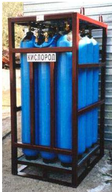
Рис. 4.35. Моноблок с кисневими балонами
