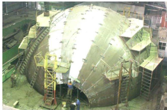
Рис. 4.24. Контрольне збирання кульового резервуара
