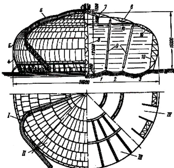
Рис. 2.41. Багатокупольний (багатоторовий) резервуар
