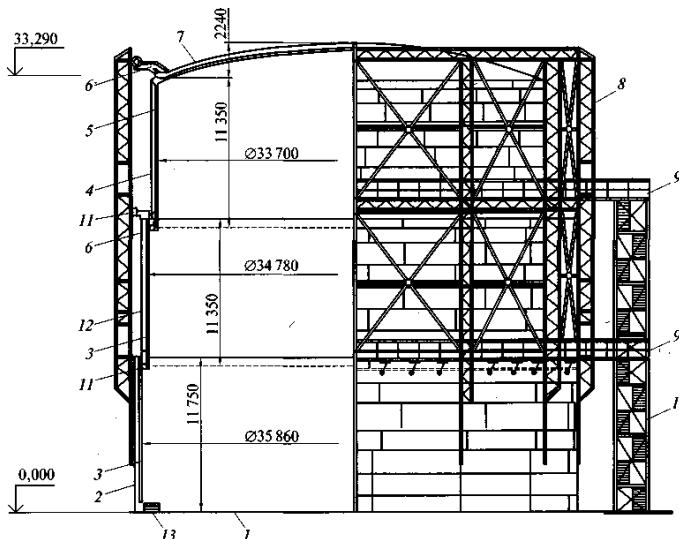
Рис. 4.7. Мокрий газгольдер низького тиску з вертикальними напрямними (всі рухомі секції складені) обсягом 20 000 м<sup>3</sup>:
