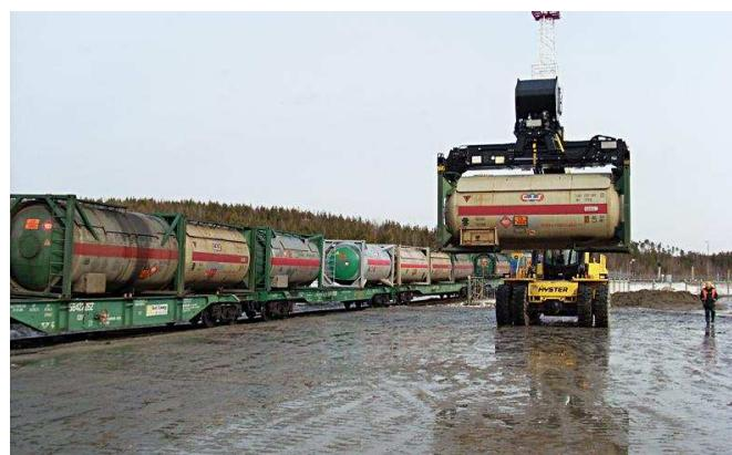
Рис. 4.71. Розвантаження 24-футових танк-контейнерів для перевезення зрідженої пропан-бутану на залізничному терміналі
