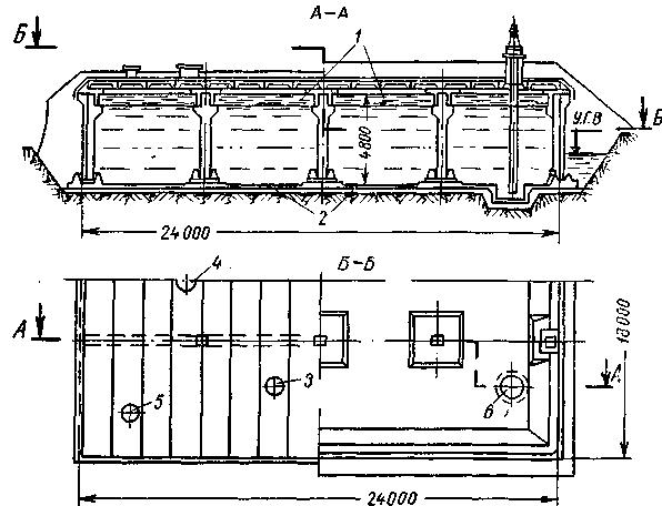
Рис. 2.80. Прямокутний збірний залізобетонний резервуар об'ємом  $2000 \text{ м}^3$ : 1 – збірне перекриття; 2 – монолітне днище; 3 – світловий люк; 4 – люк-лаз; 5 – вентиляційний патрубок; 6 – приямок
