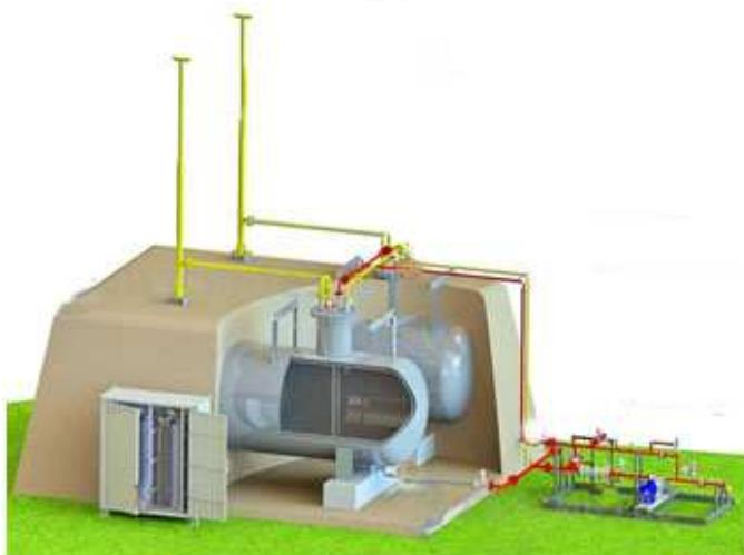
Рис. 4.86. Автомобільні газозаправні станції: а – наземна; б – підземна; в – з обваловкою резервуарів
