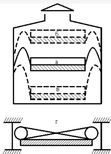
Рис. 4.14 . Принципова схема сухого газгольдера мембраниого типу (з гнучкою секцією): а – середнє положення; б – газгольдер заповнений; в – порожній; г – схема вирівнюючого пристрою
