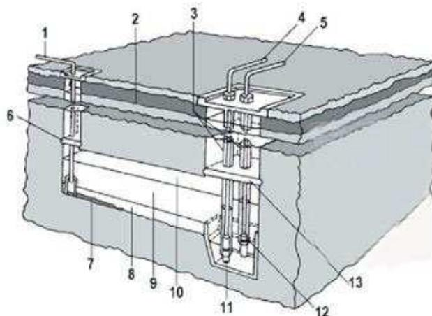
Рис. 3.2. Підземне сховище сирої нафти: 1 – приняття продукту; 2 – рівень ґрунтових вод; 3 труба- оболонка; 4 – відкачка води; 5 – видача продукту; 6, 13 – бетонна перемичка; 7 – опади; 8 – водяна подушка; 9 – рідкий продукт; 10 – газоподібний продукт; 11 – водяний насос; 12 – насос для продукту
