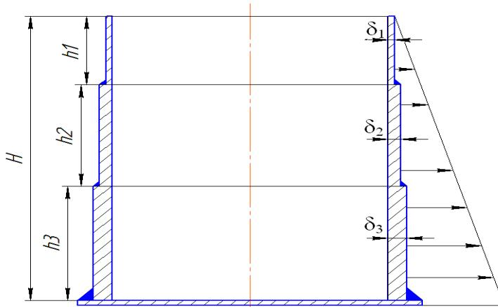
Рис. 2.77. Резервуар зі змінною по висоті товщиною стінок
