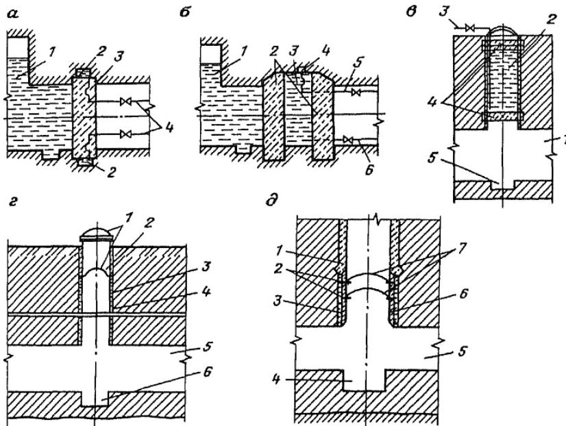
Рис.3.13. Конструкції герметизуючих пристройів:
